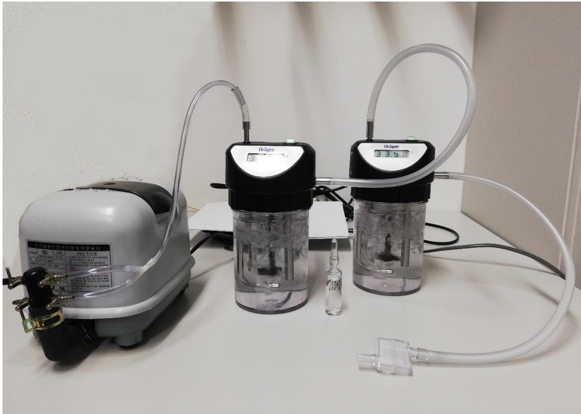
Abbildung 4: Versuchsaufbau für die Durchführung der Studie zur Überprüfung der Atemalkohol-Messgeräte. Die Membranpumpe ist auf der linken Seite sichtbar, die beiden in Serie betriebenen Simulatoren befinden sich rechts davon. Das Prüfgas wird durch den Schlauch im Vordergrund zu den Messgeräten geleitet, an dessen Ende sich eine Tröpfchenfalle befindet. Zwischen den Simulatoren befindet sich eine Ampulle mit einer Alkohol-Referenz-Lösung, wie sie zum Bereiten der Standards verwendet wird.
